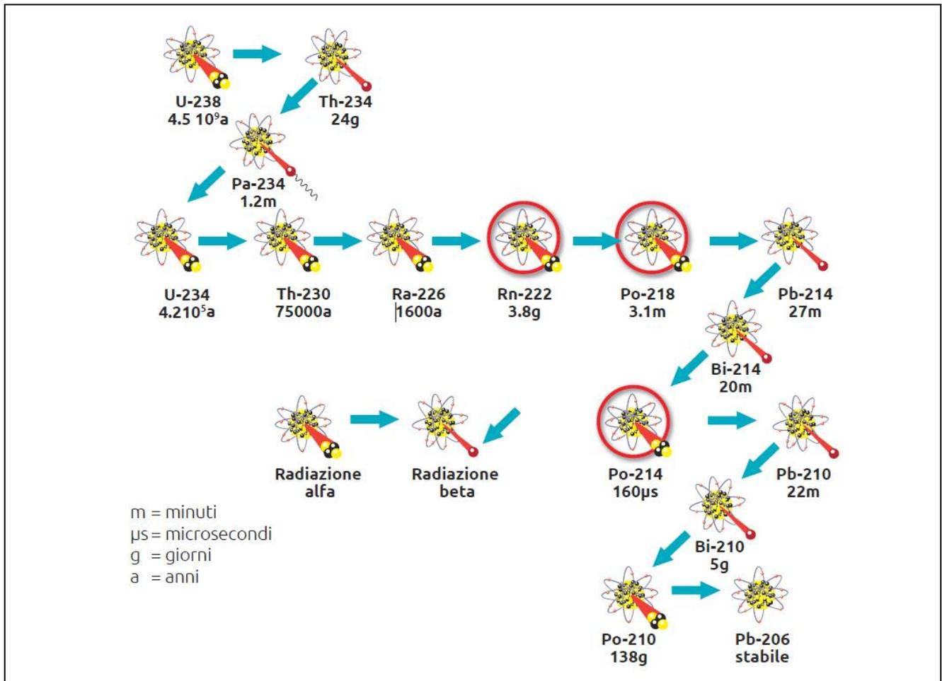
Serie di decadimento dell'uranio-238. Le frecce orizzontali indicano che nel processo di decadimento viene emessa una radiazione alfa. Sotto il simbolo di ciascun elemento è indicato il tempo di dimezzamento, ossia il tempo necessario affinché la metà degli atomi dell'elemento chimico decadano nell'elemento "figlio" immediatamente successivo indicato dalla freccia.
